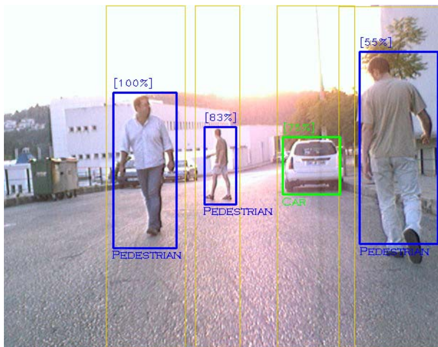
Figura 7.8: Detecção e classificação de objectos usando o classificador AdaBoost . As linhas verticais definem as ROI no plano imagem em função da informação do módulo de cooperação sensorial com o laser.
