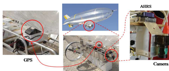
Figura 1: O dirigível não tripulado com o AHRS, câmera e GPS montados na sua gôndola.
